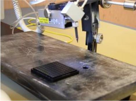
Figura 4 Pantografo Pick&Place.
