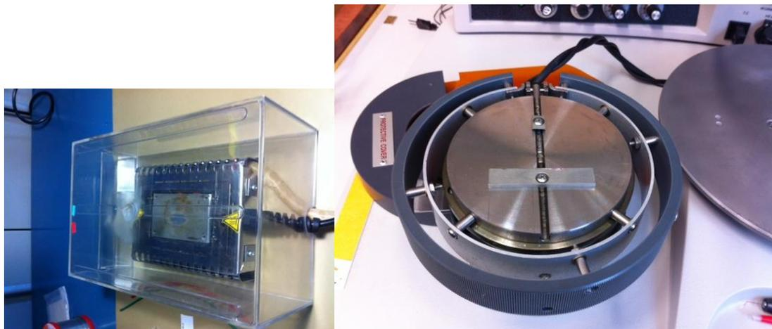
**Figura7** Sistemi adottati di essicazione e polimerizzazione dell'adesivo.
