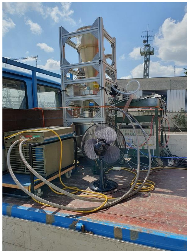
Fig. 9.2 Il ricevitore. In primo piano, in basso a sinistra, il compressore criogenico usato
