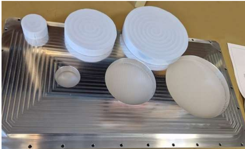
Fig. 4.5: Dischi di foam sulla finestra prima dell'incollaggio.
