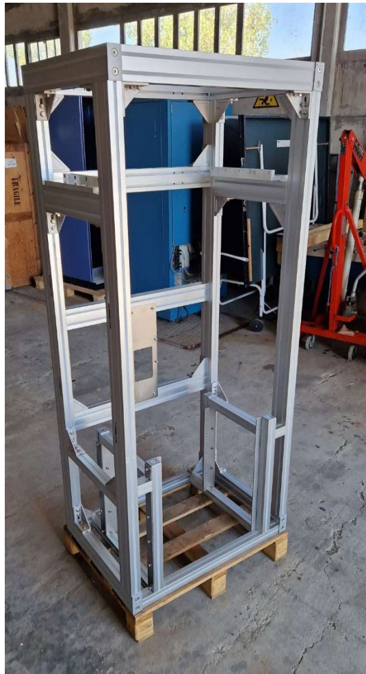
Fig. 2.1: Pre-assemblaggio della struttura di supporto
