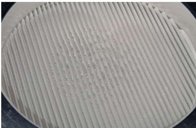
Fig. 4.1: Effetto della condensa sulla finestra del ricevitore Banda K.
