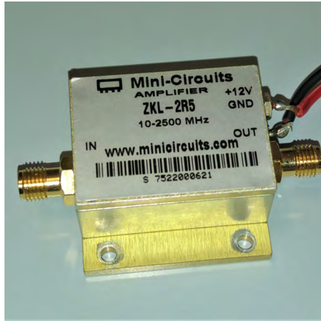
Figura 5: Amplificatore RF MiniCircuits ZKL-2R5, 10-2500 MHz
