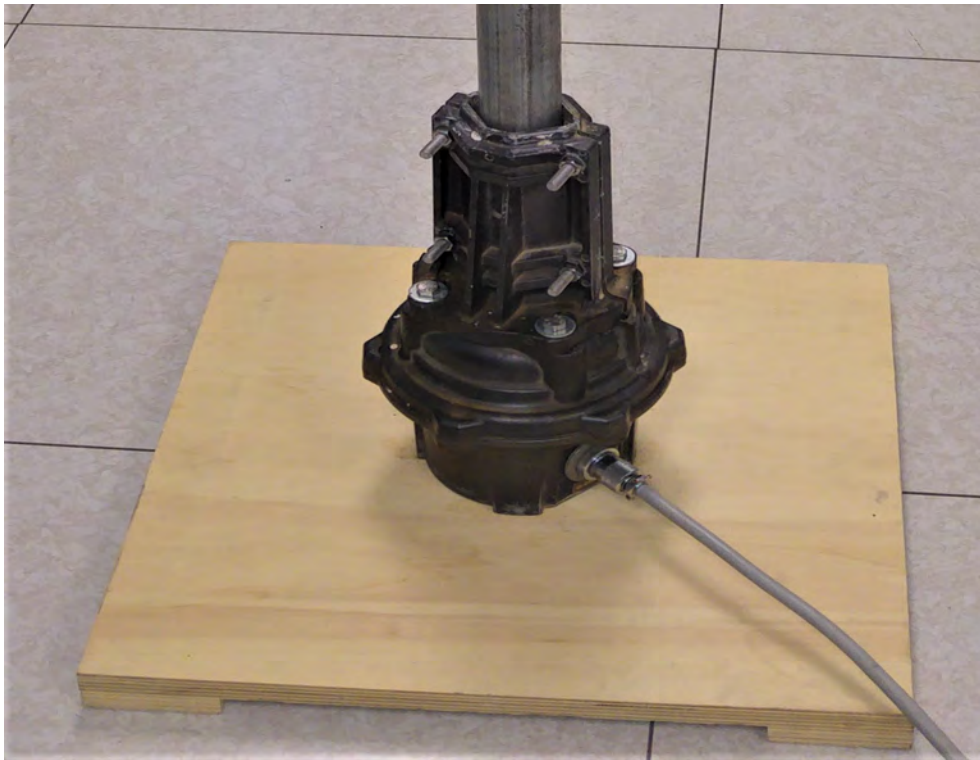
Figura 11: Rotore di antenna, unità esterna di attuazione
