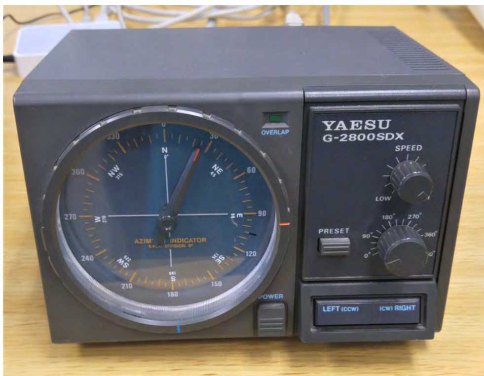
Figura 10: Rotore di antenna, unità interna di controllo
