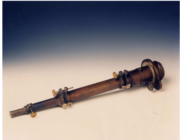
Fig. 5 – Spettroscopio applicato all'equatoriale Merz e utilizzato da Tacchini per osservazioni solari (INAF-Osservatorio Astronomico di Palermo)
