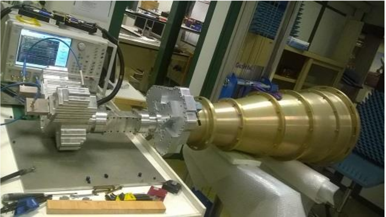
Fig. 2.1 Complessivo Horn+MarkerInjector+polarizzatore+OMT, manca la finestra da vuoto
