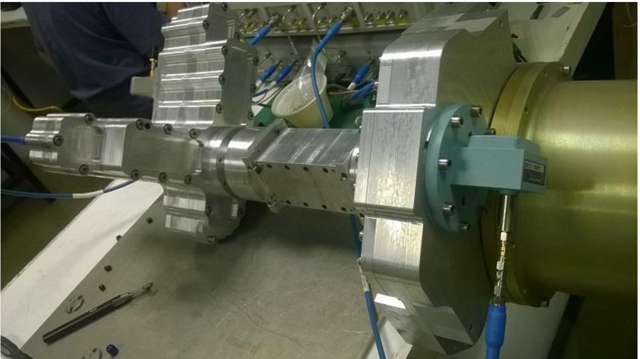
Fig. 2.2 Particolare: Iniezione segnale di marca+polarizzatore+OMT, manca la finestra da vuoto
