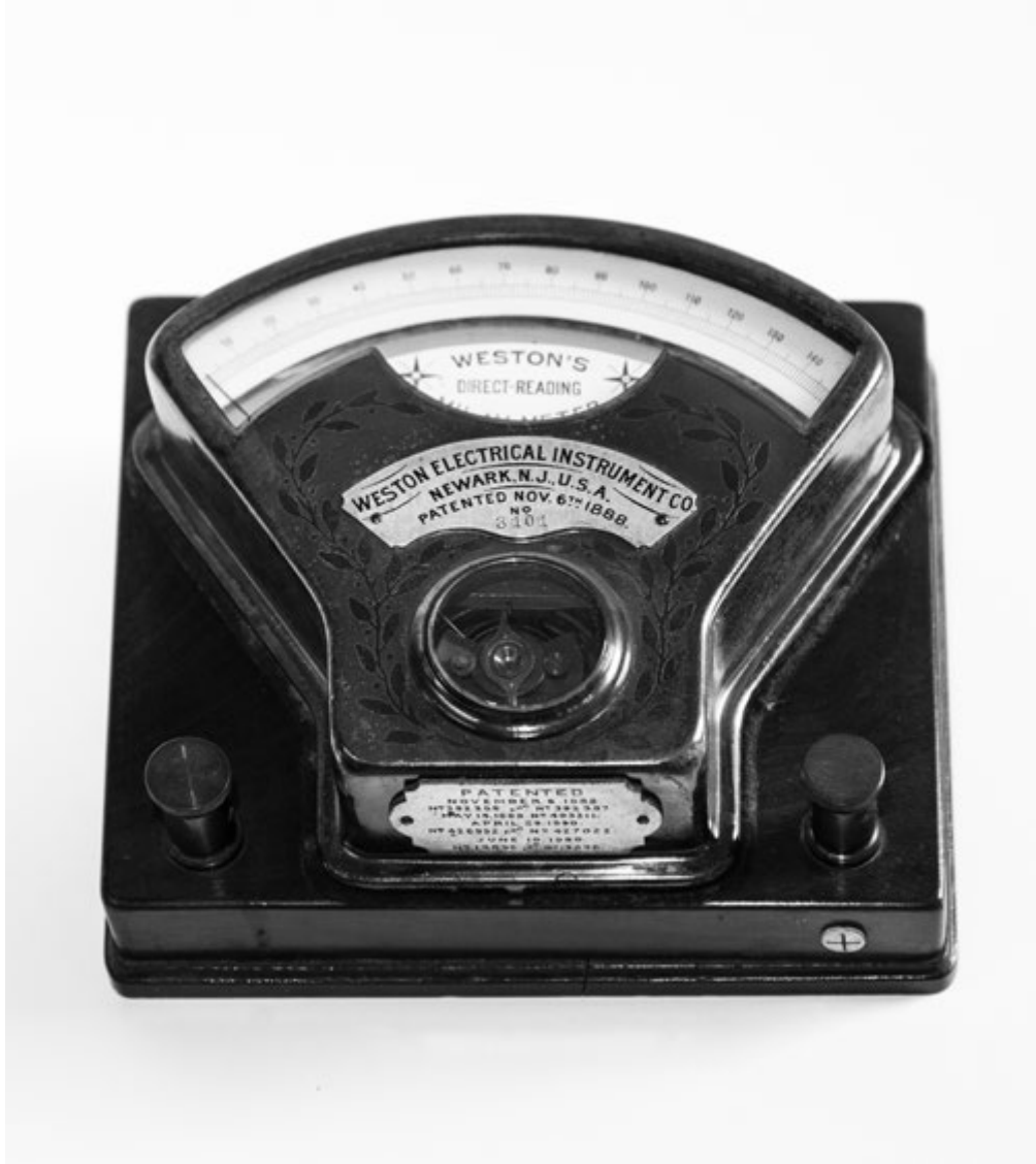
Fig. 4 – Milliampmetro da laboratorio della ditta americana Weston simile a quello illustrato nella fig. 4. [Dipartimento di Fisica e Astronomia, Università di Firenze]
