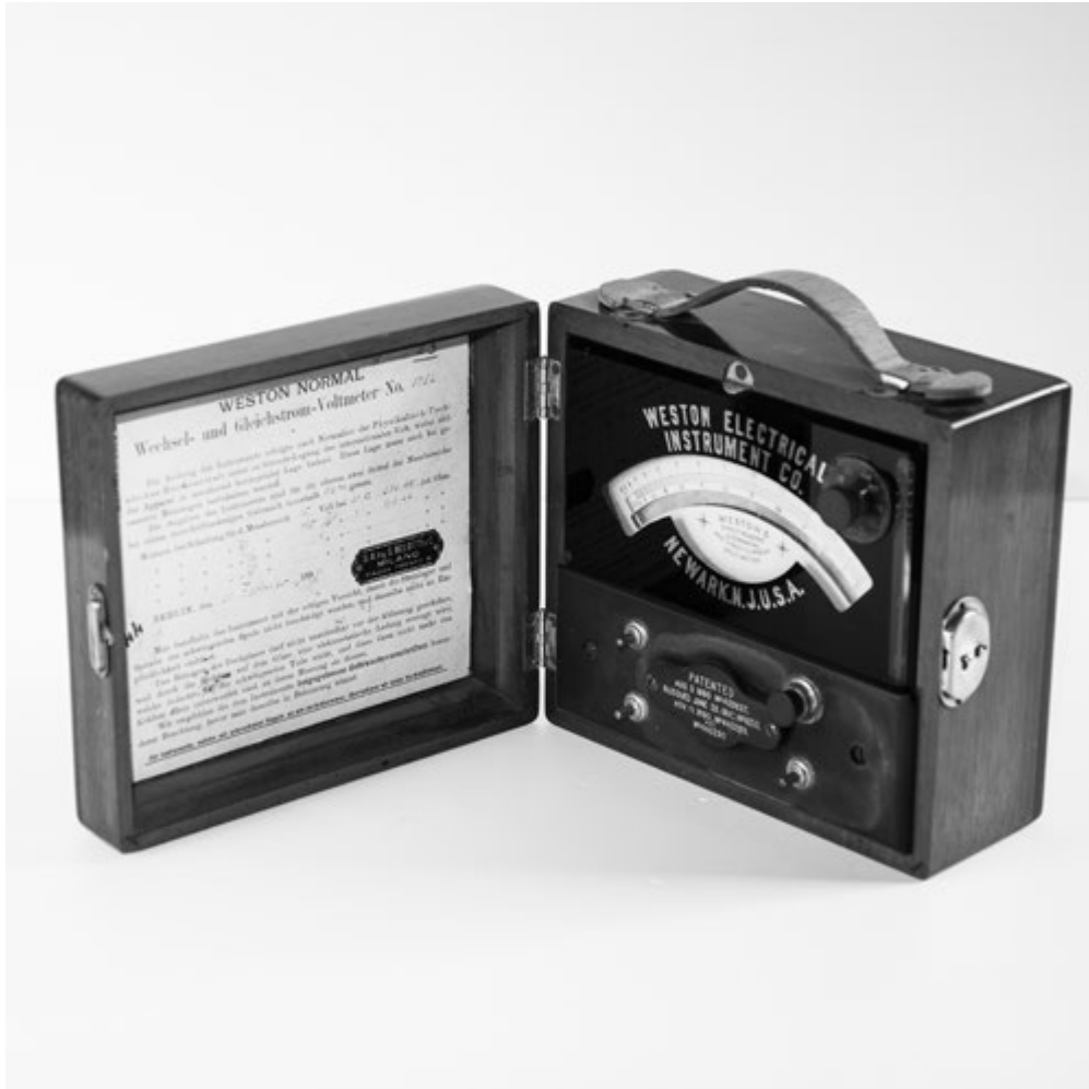
Fig. 3 – Milliamperometro Weston Electrical Instrument Co, Newark, N. J. USA. Dimensioni larghezza cm 20, profondità cm 18, altezza cm 11. Lo strumento, inserito in scatola di legno, è del tipo ideato da Edward Weston alla fine dell'Ottocento. L'equipaggio mobile è composto da una bobina impernata fra i poli di un potente magnete permanente. Questi strumenti a misura diretta, solidi, affidabili, erano diffusissimi e in forma più moderna sono utilizzati ancora oggi. [Dipartimento di Fisica e Astronomia, Università di Firenze]
