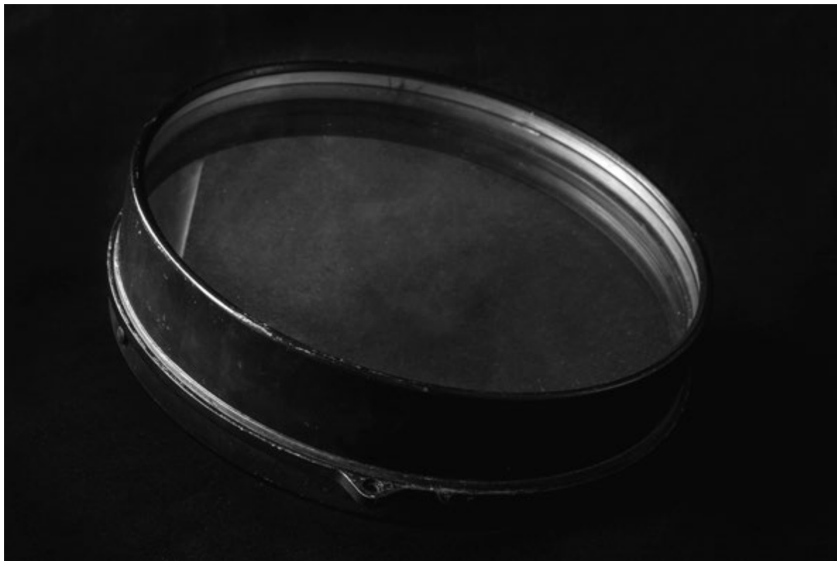
Fig. 13 – L'obiettivo Zeiss della Torre Solare, apertura 30 cm, focale 18 m. [INAF-Osservatorio Astrofisico di Arcetri]
