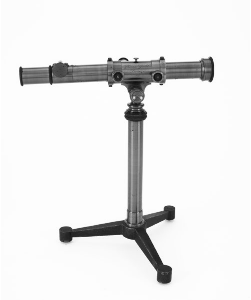
Fig. 8 – Spettroscopio a visione diretta per uso astronomico, sec. XIX. [Museo Galileo]
