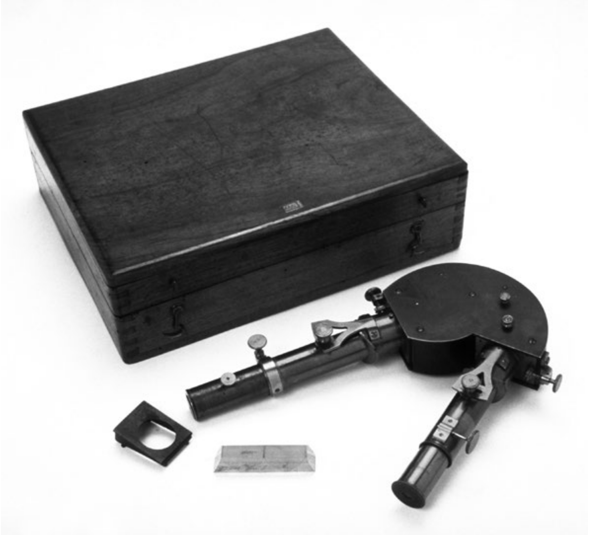
Fig. 11 – Spettroscopio a 25 prismi utilizzato dal primo direttore dell'Osservatorio di Arcetri, Giovan Battista Donati, per analizzare la radiazione stellare, c.1872. [Museo Galileo]
