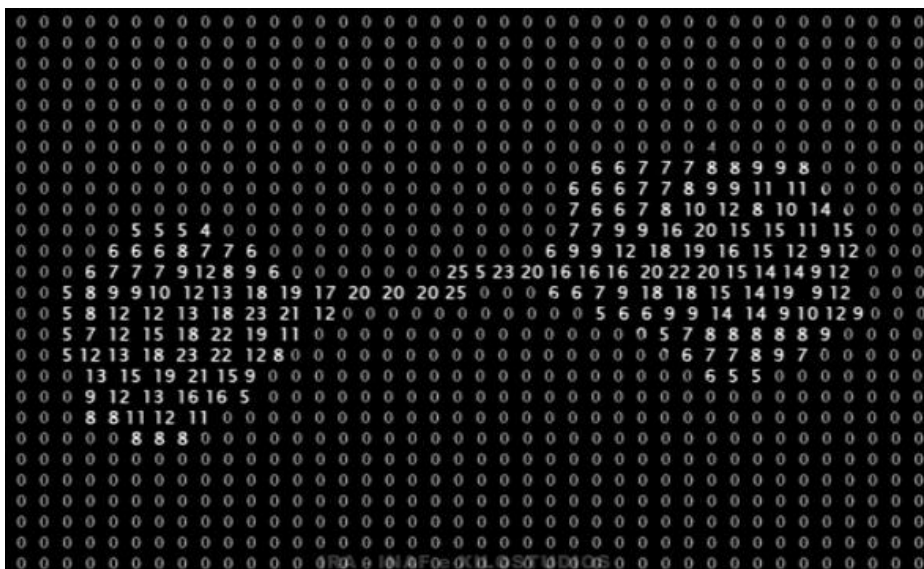
Figura 36 Intensità delle onde radio celesti convertite in numeri attraverso un software specifico per l'analisi dati. I numeri diversi da zero sono stati resi più luminosi per evidenziare la struttura dell'emissione radio 3 .
