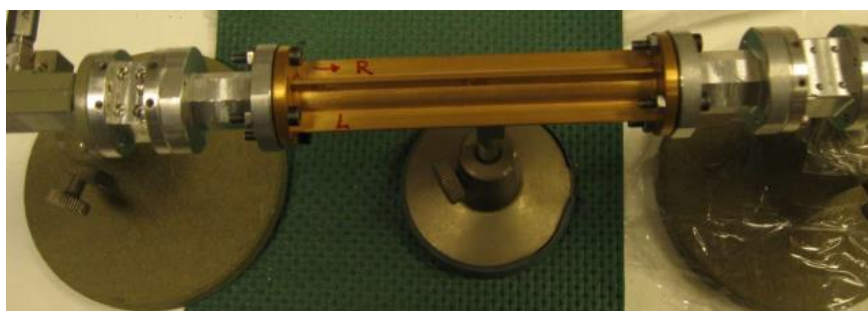
Fig. 5.1 Uno dei 19 polarizzatori costruiti nella sua fase di caratterizzazione
