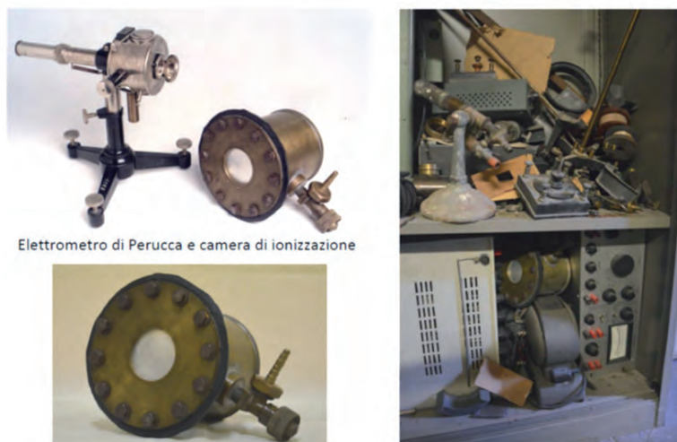
Fig. 7. L'elettrometro di Perucca, la camera di ionizzazione e il luogo in cui sono stati ritrovati
