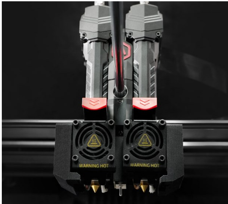
Fig. 4– Kit estrusione, costituito da estrusori e ventole di raffreddamento. Al centro sono presenti le levette di sgancio rapido degli estrusori.
