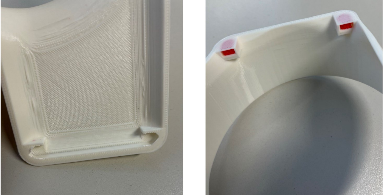
Fig. 30 – A sinistra viene mostrato come l'adesione fra layer di supporto e layer di contenimento delle calamite si sia rotto a causa dell'unione dei supporti all'interno dell'alloggiamento con il layer di supporto attaccato al piano. A destra invece i supporti non erano attaccati al piano pertanto sono rimasti inseriti all'interno dell'alloggiamento.
