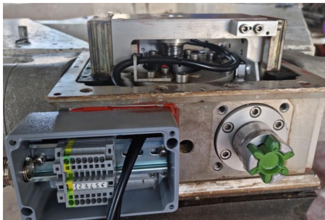
Figura 6-3 Dettaglio scatola di derivazione e accoppiamento motore
