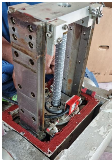
Figura 6-1 Dettaglio sensore fine corsa assi Zsr
