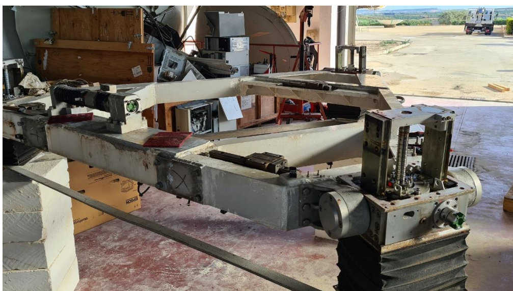
Figura 5-3 Smontaggio e pulizia telaio del subriflettore
