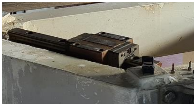
Figura 6-2 Dettaglio carrello asse Xsr
