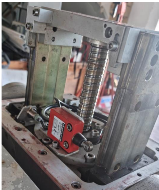
Figura 6-4 Dettaglio fine corsa e relativa camma asse Zsr
