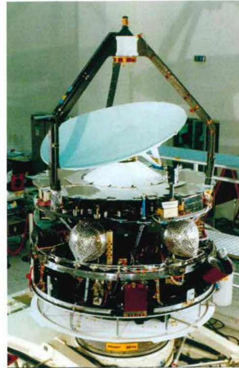
La sonda 'spogliata' dei pannelli solari per consentire l'accesso all'interno. Nella piattaforma principale sono visibili due delle 4 sfere d'argento, che costituiscono i serbatoi dell'idrazina, il combustibile necessario per correggere l'orbita e l'assetto della sonda. Sulla
