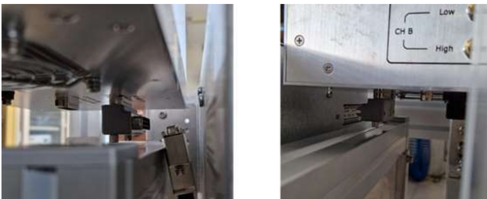
Fig. 2.6: Interferenza meccanica tra connettori e struttura.
