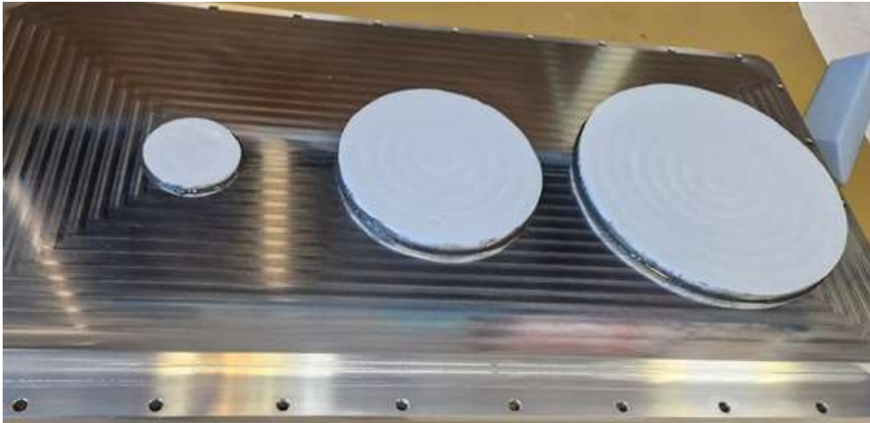
Fig. 4.6: Dischi incollati sulla flangia delle finestre dei tre ricevitori del CTR.
