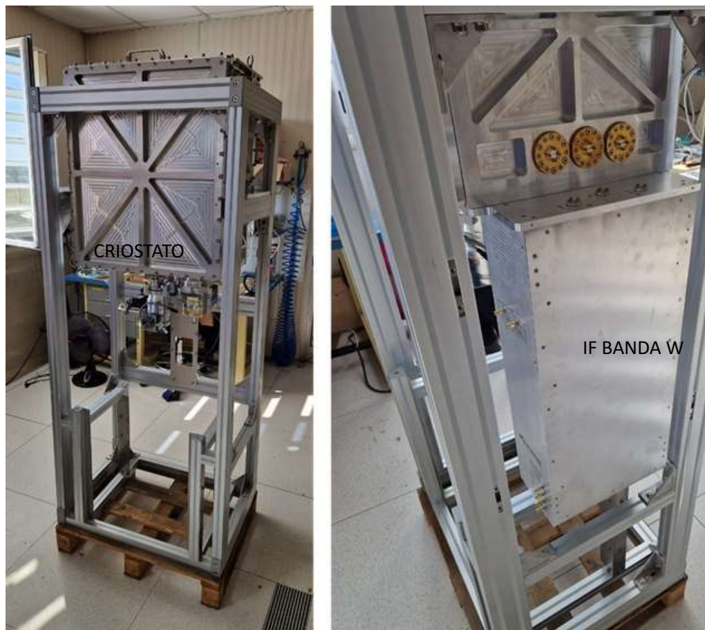
Fig.2.2: Struttura di supporto, camera criogenica (a sinistra) e parte calda Banda W (a destra) nel Lab Microonde
