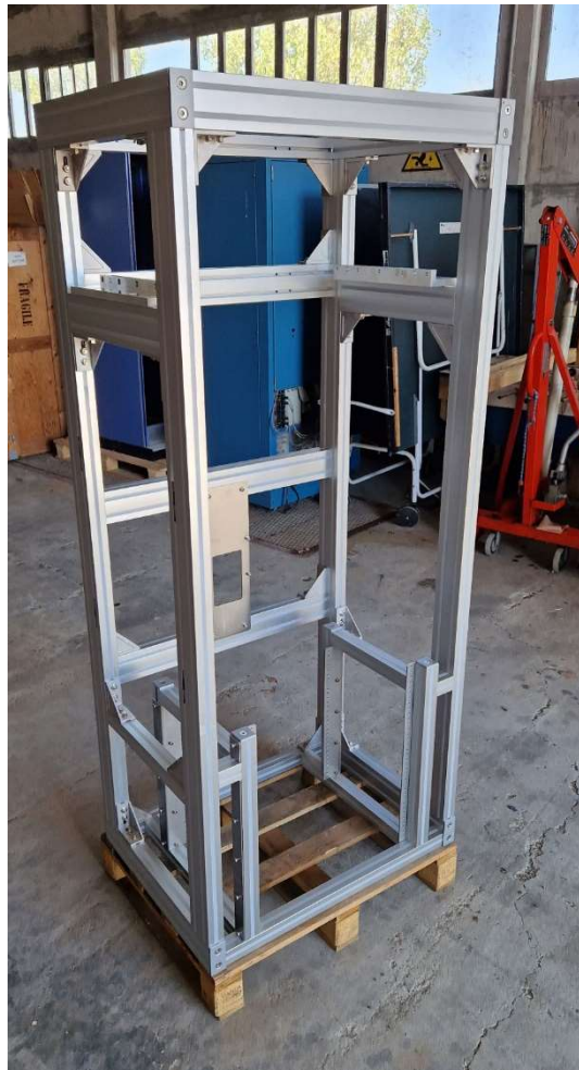
Fig. 2.1: Pre-assemblaggio della struttura di supporto
