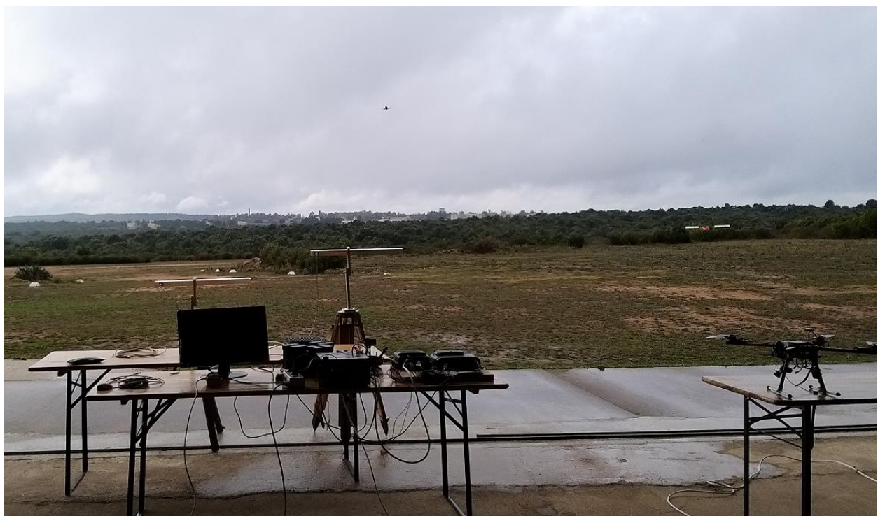
Figura 56. Test operativi sul prototipo RADAR in banda C.
