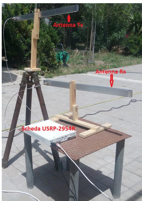
Figura 37. Fotografia del prototipo in banda C senza amplificatore.
