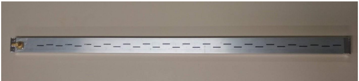
Figura 22. Antenna WSA in banda X senza lo schermo posteriore.
