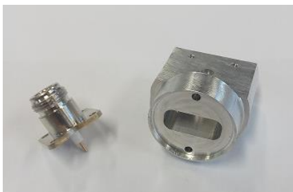
Figura 10. Transizione guida cavo e connettore R16146130 utilizzato.
