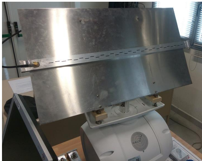
Figura 23. Antenna WSA con lo schermo posteriore montata sul blocco RADAR
