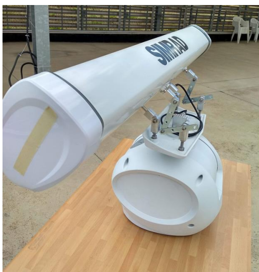
Figura 13. Blocco RADAR del SIMRAD con le modifiche installate
