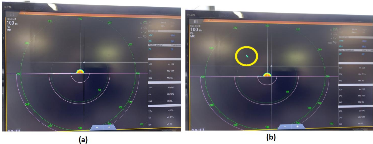
Figura 55. Test operativi sul RADAR SIMRAD. (a) PPI in assenza di bersagli. (b) Bersaglio correttamente rilevato (evidenziato dal circolo giallo).
