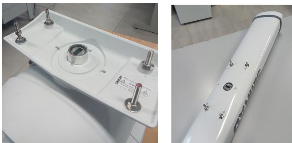
Figura 4: Collegamento tra il blocco RADAR e l'antenna del SIMRAD HALO 3.
