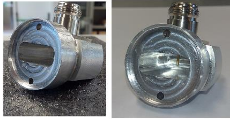
Figura 11. Transizione guida cavo completa.
