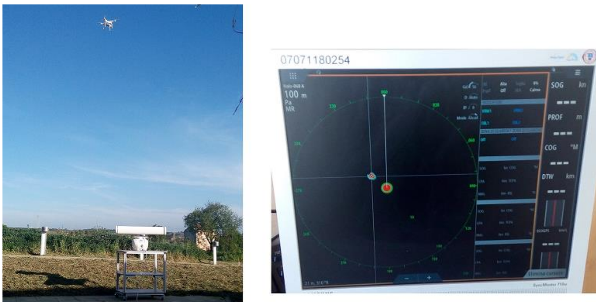
Figura 16. Rilevamento del drone bersaglio sul PPI del SIMRAD HALO 3.
