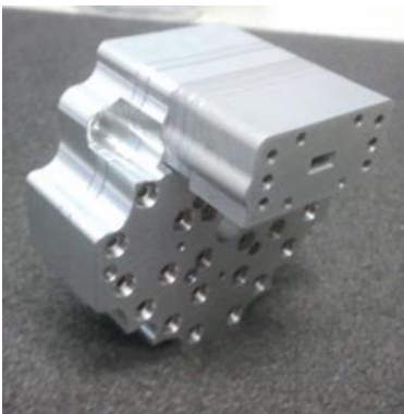
Fig. I.2. Uno dei 19 marker injector . In evidenza la guida rettangolare che funge da porta d'ingresso per il segnale di marca. Sotto questa guida si intravede, al centro del pezzo sottostante, la guida circolare che permette il passaggio del segnale principale a cui la marca andrà a sovrapporsi.
