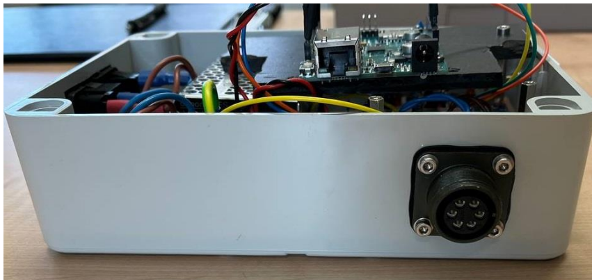
Figura 6. Lato sinistro e lato destro box; connettori militari a 6 poli Maschio e Femmina rispettivamente.
