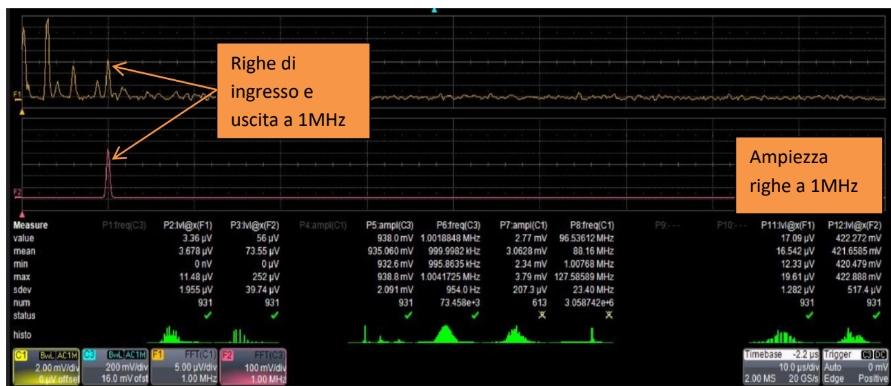
Figura 12. In basso lo spettro del segnale d'ingresso, mentre in alto quello del segnale di uscita.
