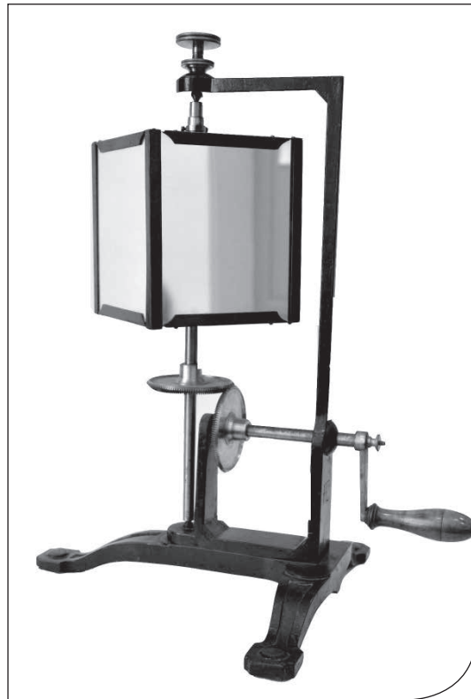
Fig. 10. Apparato a specchi rotanti (Collezione Storica degli Strumenti di Fisica dell'Università di Palermo).
